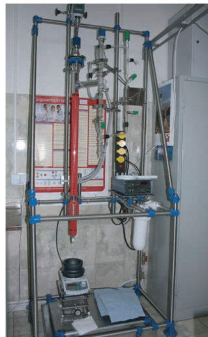
Instalația de distilare cu bandă de teflon rotitoare.
