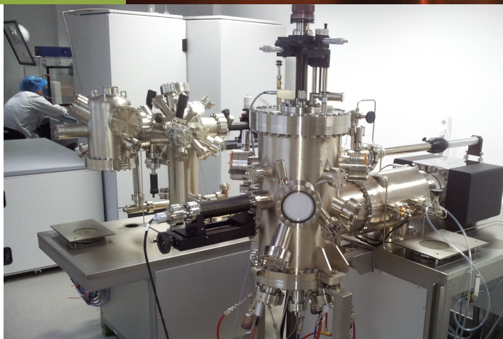
Instalație de Epitaxie prin Fascicul Molecular cuplat cu STM în Clean Room 2.
