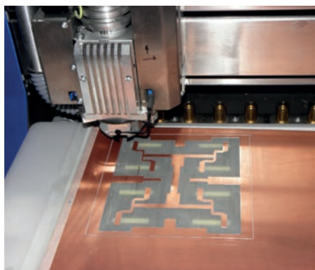
Antena microstrip cu fante în timpul procesului de frezare pe ploterul LPKF Protomat S62.
