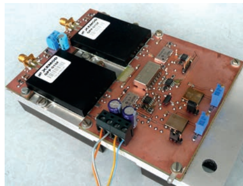
Prototipul unui amplificator RF de putere (915 MHz) cu două canale de 60 W, pentru uz științific (diatermie în câmp de microunde).
